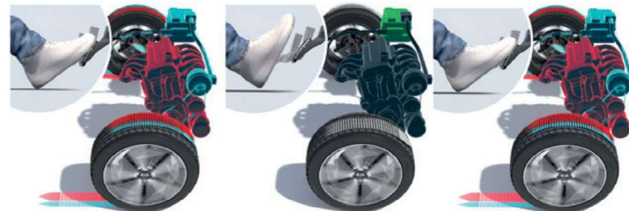
Zjednodušené zobrazení funkce setrvačné jízdy u verze Mild Hybrid
