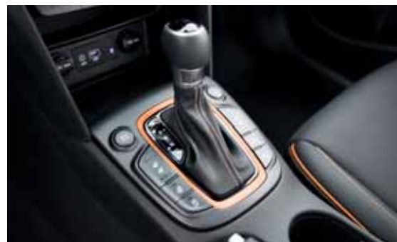
Sedmistupňová dvouspojková převodovka DCT s automatickým řazením a možností manuálního režimu
