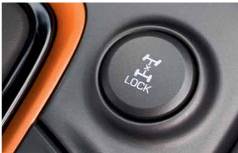
Uzamykatelné rozložení točivého momentu mezi nápravami v poměru 50:50
